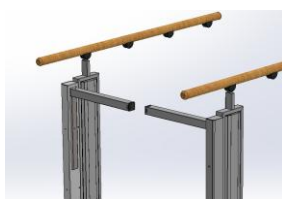
Abb. 2: Automatische Platt- formbarriere (Sonderausstattung) hebt und verriegelt sich
